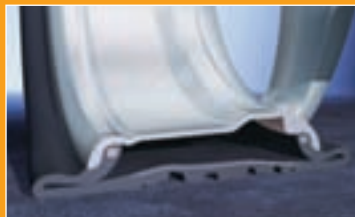
Pneus convencionais vazios: o pneu fica inutilizado numa curta distância.
